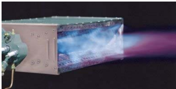
Air Heater Brülörü Yanarken
